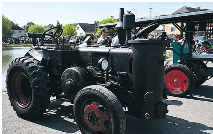
Traktor LANZ BULLDOG r.v. 1943, upravený pro spalování dřevoplynu.
